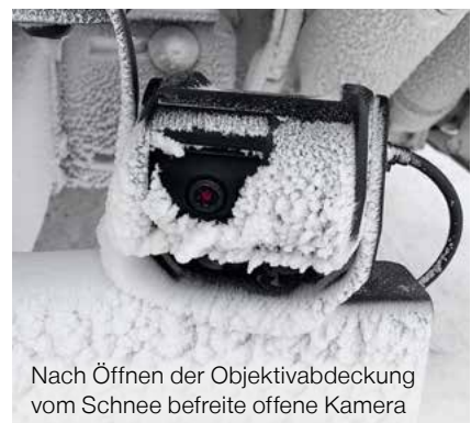
„Augenlid“-Effekt beim Öffnen der Objektivabdeckung
