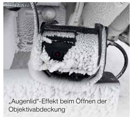
Kamera auch bei Schneefall durch Shuttergehäuse einsatzbereit
