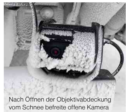
„Augenlid“-Effekt beim Öffnen der Objektivabdeckung
