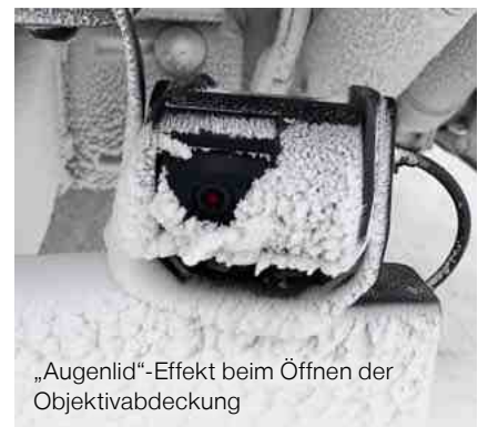
Kamera auch bei Schneefall durch Shuttergehäuse einsatzbereit
